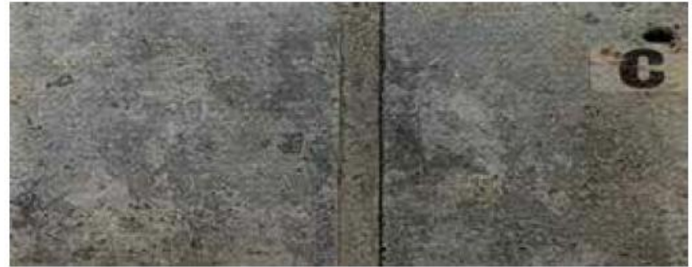
Kuva 10-11. Paksuudeltaan 60 \mu\text{m} olevaan sinkkierrokseen on jyrsitty 6 mm leveä ura, joka ulottuu teräkseen saakka. Näyte on sitten asetettu alttiiksi rasittavalle teollisuusmeri-ilmastolle Alankomaissa 5 vuoden ajaksi. Huomaa sinkkisuoloista koostuva pinnoitekerros urassa sekä ruosteen täydellinen puuttuminen.
