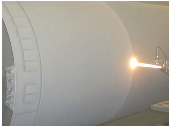
Kuva 1. Paperikoneen keskitelan HVOF-ruiskutusta korroosiokestäväällä metalliseoksella. Lähde: MetsoPaper Inc.
