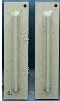
Kuva 5: Ponsse Oyj suihkupuhdistettuja hitsausroiskelevyjä.
