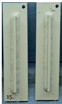
Kuva 14: Ponsse Oyj suihkupuhdistettuja reunahaavalevyjä.
