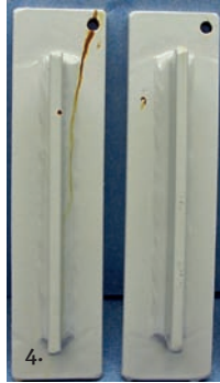
Kuva 2: Ponsse Oyj suihkupuhdistettuja vertailulevyjä.
