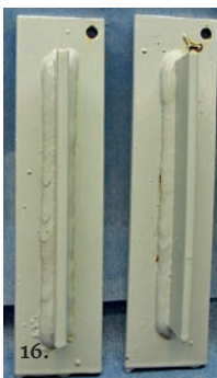
Kuva 14: Ponsse Oyj suihkupuhdistettuja reunahaavalevyjä.
